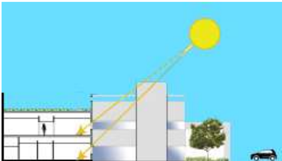
Ilustración 12 Corte Ganancia Solar Directa
